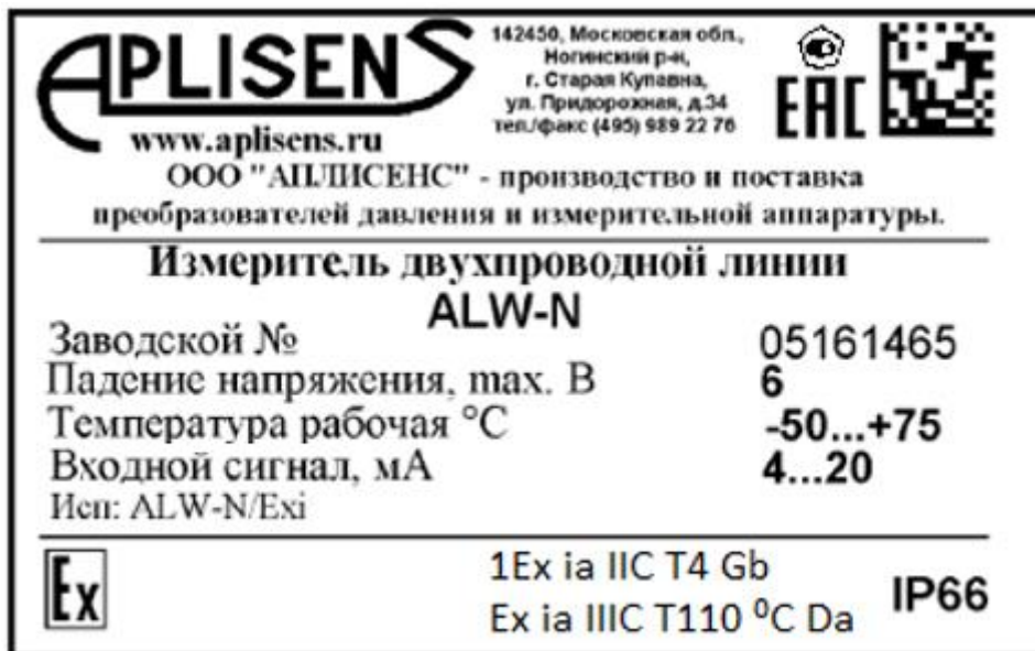
Рис. 2. Пример идентификационной таблички измерителя двухпроводной линии ALW-N в Ex исполнении
