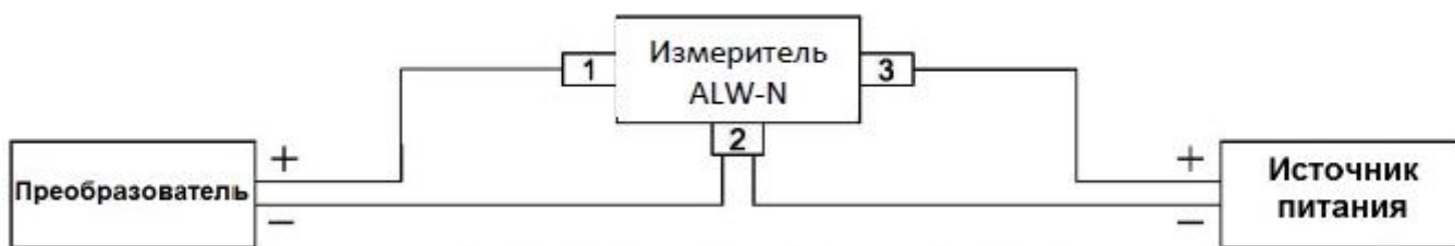
Рис.5. Схема подключения измерителя ALW-N без HART коммуникации
